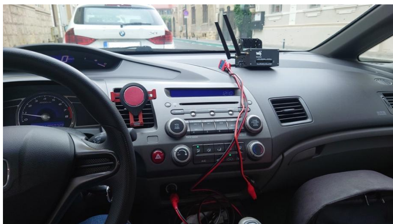
Figura 18. Sistemul de achiziție și procesare instalat în interiorul autovehiculului.
